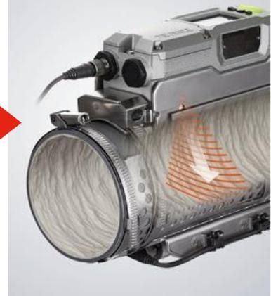
Falls Ablagerungen erkannt werden, wird die Leistung des Ultraschallsignals automatisch angepasst und erhöht.
